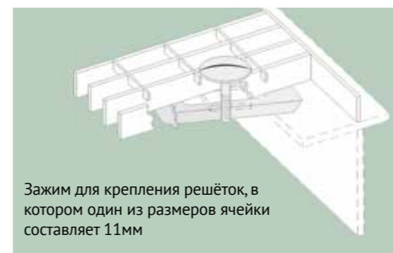
Крюковой зажим Крюк выполнен из прутка 8 мм с приваренной специальной гайкой. Болт М8х70 или М8х100 по DIN 558
