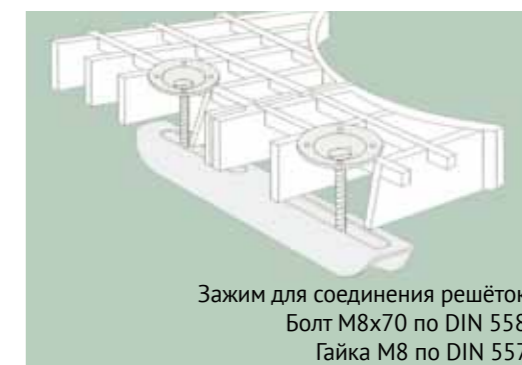
Крюковой зажим Крюк выполнен из прутка 8 мм с приваренной специальной гайкой. Болт М8х70 или М8х100 по DIN 558
